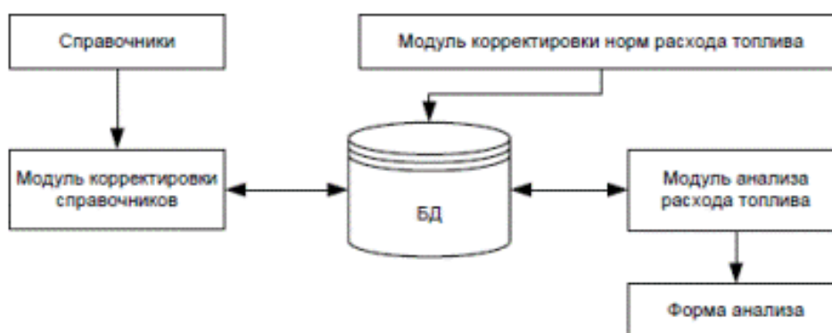
Рис.5.7 Функциональная схема АРМ техника по учету топлива
