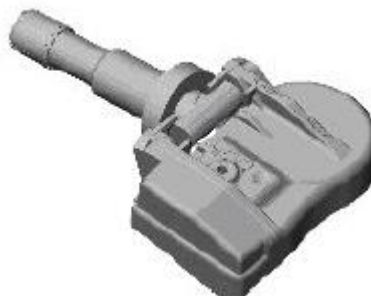
Рис.3. Датчик давления в шине Discovery Sport
