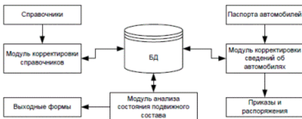
Рис. 5.4 Функциональная схема АРМ технического отдела
