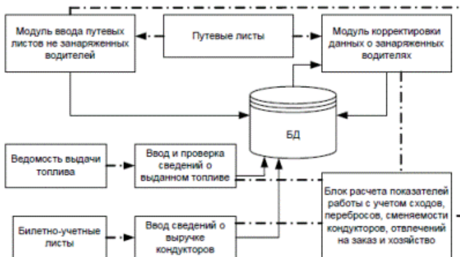
Рис. 5.6 Функциональная схема АРМ таксировки путевых листов
