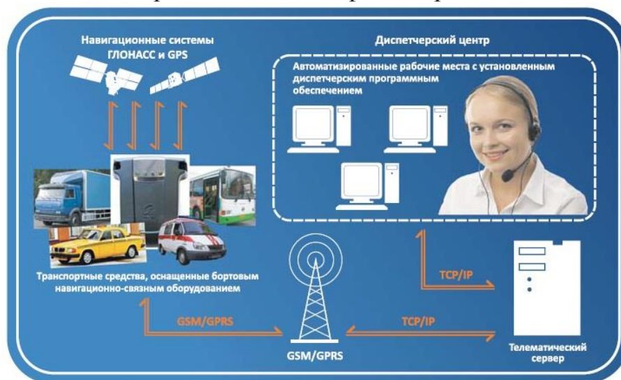
Рис. 1. Общая схема функционирования системы спутникового мониторинга транспорта
