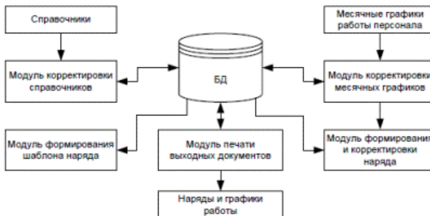
Рис.5.5 Функциональная схема АРМ диспетчера
