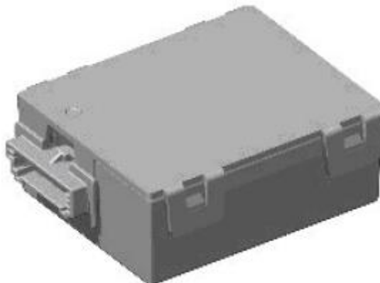
Рис.2. Блок контроля давления в шинах Discovery Sport (TPM)
