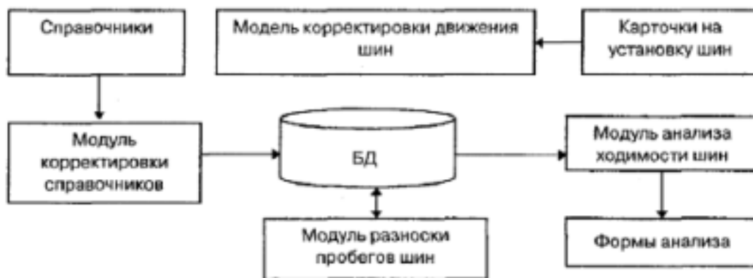
Рис. 5.8 Функциональная схема АРМа техника по учету ресурса шин
