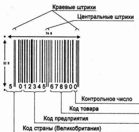
Рис. 14.2 – Структура кода EAN-13
